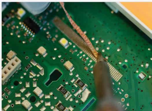
Dopo aver dissaldato il display originale, pulire con treccia dissaldante i contatti per eliminare lo stagno in eccesso. E' consentito l'uso del flussante.
