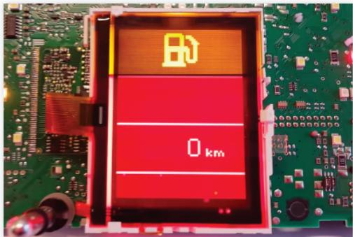
Testare il contachilometri fornendo alimentazione sul connettore blu:
