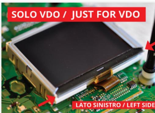
Posizionare il flat ripiegandolo sotto il display. Assicurarsi che le parti in plastica non esercitino pressione sul flat una volta rimontate. Se questo dovesse verificarsi, cercare una migliore posizione per il flat.
